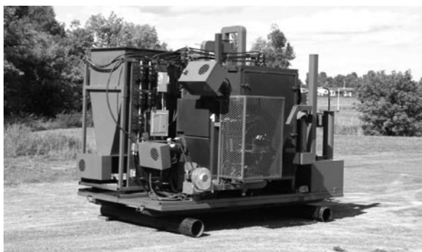
FIGURA 3. UNA PLANTA DE PIRÓLISIS PORTÁTIL PARA LA PRODUCCIÓN DE BIOACEITES, GAS SINTÉTICO Y BIOCHAR A PARTIR DE LA CONVERSIÓN DE RESIDUOS AGRÍCOLAS
